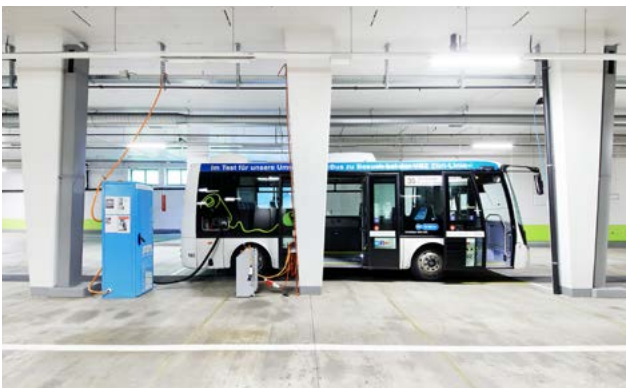
Batteriebus an der Ladestation in der Garage Hardau (Bild: VBZ)
